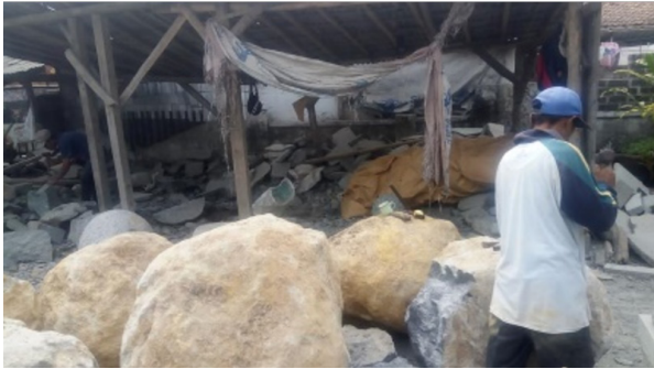
Gambar 3. Pengrajin yang sedang membersihkan permukaan bongkahan-bongkahan Batu andesit. Sumber: Dokumentasi Pribadi (2019)
