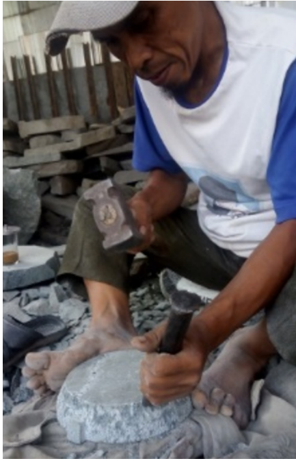
Gambar 7. Tahap Pembentukan Sumber: Dokumentasi Pribadi (2019)
