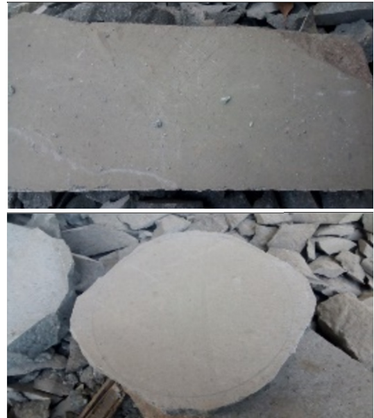
Gambar 6. Sebelum dan sesudah diberi sketsa dan dipotong pinggirannya sedikit demi sedikit. Sumber: Dokumentasi Pribadi (2019)
