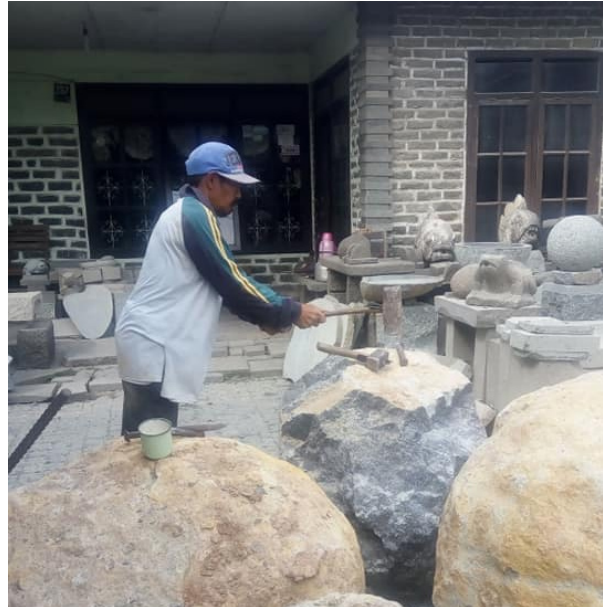
Gambar 2. Pekerja yang sedang memecah bongkahan batu Andesit berukuran Besar
