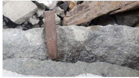
Gambar 5. Batu andesit bakal yang telah dibelah Sumber: Dokumentasi Pribadi (2019)
