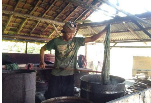
Gambar 9. Proses pelorodan pada batik cap (Sumber: Hanifah Nurul Muslimah, 2021)
