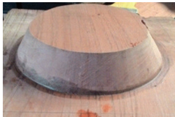
Gambar 8. Hasil pemotongan menggunakan jigsaw dengan kondisi blade gergaji bengkok mengakibatkan lingkarannya tidak sinkron antara bagian atas dan bawahnya (Sumber: Dokumentasi Tim Peneliti, 2018)
