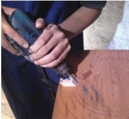
Gambar 5. Proses melubang menggunakan mesin bor dengan mata bor ukuran 3 mm (Sumber: Dokumentasi Tim Peneliti, 2018)
