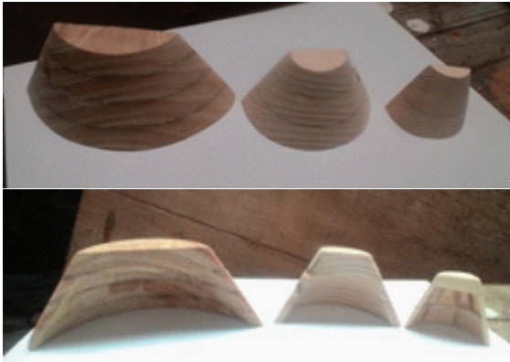
Gambar 3. Simulasi tiga jenis potongan yang berbeda dengan menggunakan bidang bulat dengan laminasi sebanyak tiga lapis menggunakan lem PVaC (Sumber: Dokumentasi Tim Peneliti, 2018)
