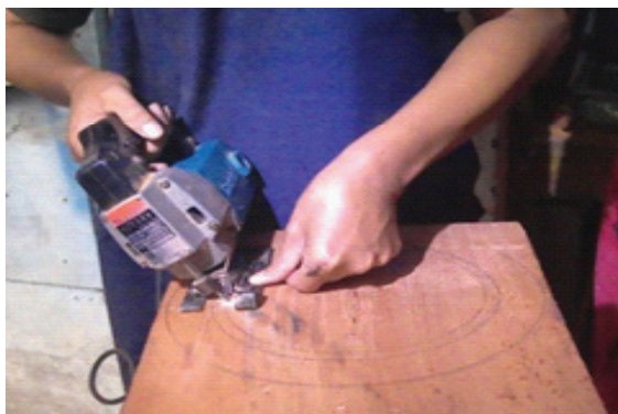
Gambar 7. Pemotongan miring menggunakan mesin jigsaw (Sumber: Dokumentasi Tim Peneliti, 2018)
