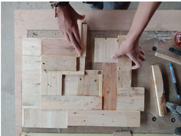
Gambar 5. Sisa potongan kayu disusun ulang
