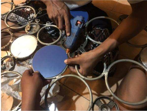
**Gambar 14. Proses pemasangan kaca cermin**
