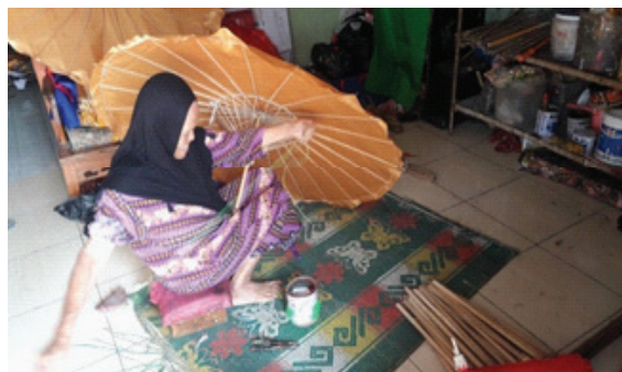
Gambar 3. Proses menggabungkan rangka dengan tudung (Foto: Dokumentasi Tim Peneliti, 2018)
