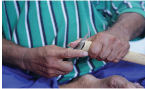
Gambar 8. Merapikan potongan pangkal dan ujung saluang (Foto: Ediwar, dkk., 2018)
