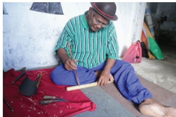
Gambar 14. Penyempurnaan bulatan lobang nada dengan ruyung panggis a (Foto: Ediwar, dkk., 2018)
