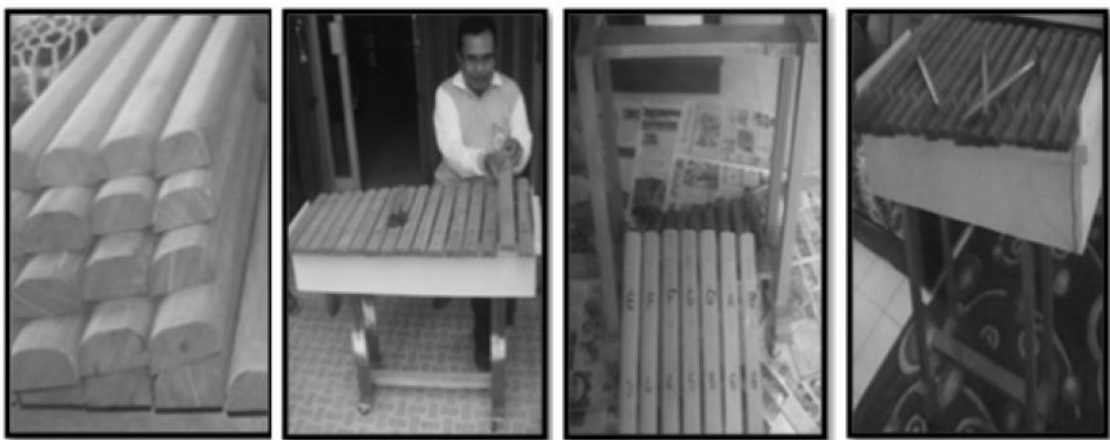
Gambar 5. Tahapan Pembuatan Kolintang Pengirim untuk Prototype Abakod (2013)
