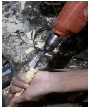
(Gambar 6. Pembolongan sambungan pureut menggunakan bor, dokumentasi Euis Karmila, 2022)
