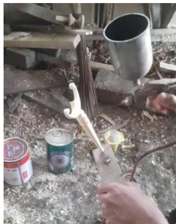
(Gambar 9. Finishing, proses mengecat, pureut dan pucuk, dokumentasi Euis Karmila)
