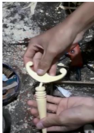
(Gambar 7. Pemasangan pureut ke dalam lubang yang sudah dibor, dokumentasi Euis Karmila, 2022)
