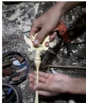
(Gambar 8. Pemasangan pucuk ke dalam lubang yang sudah dibor (Dokumentasi Euis Karmila, 2022)
